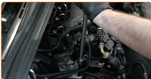
**20** Retire el soporte por debajo del motor.
