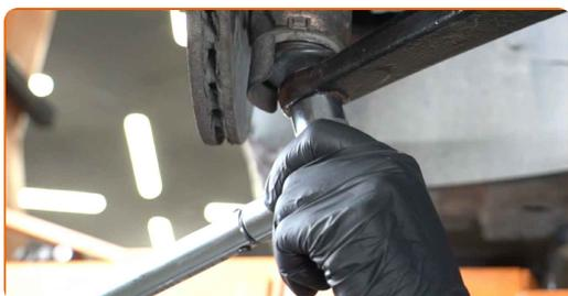
**40** Trate las sujeciones de la rótula. Trate las sujeciones del amortiguador. Use grasa de cobre.
