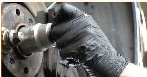
**37** Instale el pasador de chaveta de la tuerca del eje CV. Use una palanca. Utilice un martillo.
