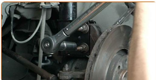
**36** Apriete la tuerca del eje de transmisión. Use un vaso de impacto del n.º 36. Utilice una llave dinamométrica. Apriételo a un par de 280 Nm.
