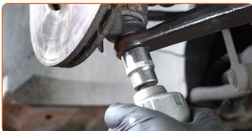
**39** Apriete la fijación del soporte esférico. Use un vaso de impacto del n.º 21. Utilice una llave dinamométrica. Apriételo a un par de 50 Nm.
