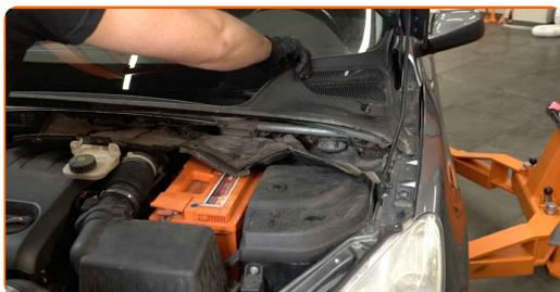
**10** Limpie las sujeciones del soporte superior del puntal amortiguador. Use un cepillo de alambre. Use el aerosol WD-40.
