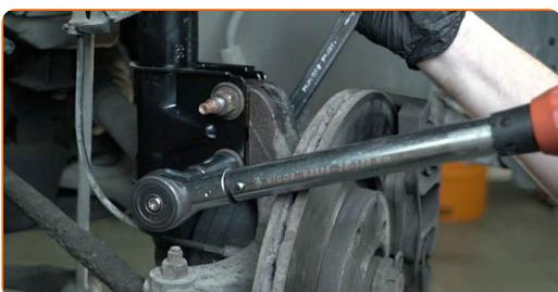
**64** Trate las sujeciones del amortiguador. Use grasa de cobre.
