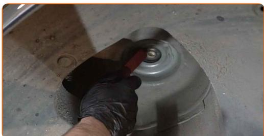
**51** Instale la pata amortiguadora en el arco de la rueda.
