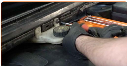
**7** Retire los clips de la rejilla de ventilación plástico del capó. Utilice una herramienta de extracción de clips.
