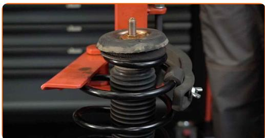
**49** Retire el puntal amortiguador que está montado.
