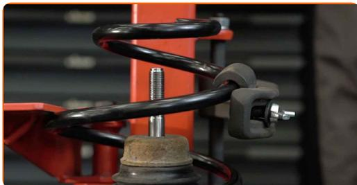
**45** Instale el soporte de montaje superior del puntal y el cojinete del soporte de montaje del puntal.
