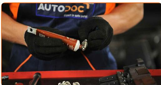
**12** Instale las nuevas bujías en sus asientos de montaje. Use el vaso de bujía # 16.
