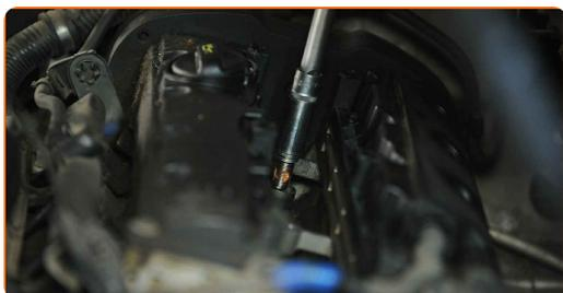
**13** Atornille las bujías nuevas y apriételas. Use el vaso de bujía # 16. Utilice una llave dinamométrica. Apriételo a un par de 25 Nm.
