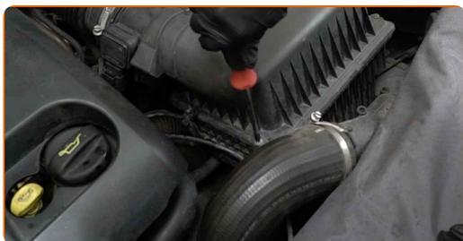
**4** Levante ligeramente la cubierta de la carcasa del filtro de aire.
