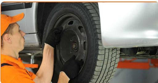
**7** Limpie las sujeciones del soporte de la pinza del freno. Use un cepillo de alambre. Use el aerosol WD-40.
