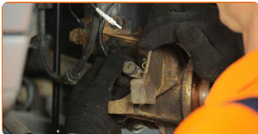
**32** Limpie la sujeción inferior que conecta el puntal de suspensión con la mangueta de dirección. Use un cepillo de alambre. Use el aerosol WD-40.
