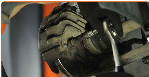
**76** Conecte la clavija del sensor de desgaste de las pastillas de freno.
