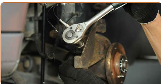
**62** Conecte la punta de la barra de dirección al muñón de dirección.
