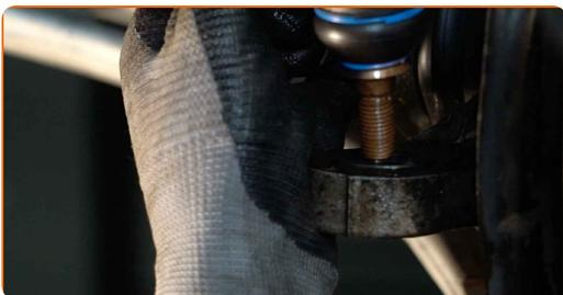
**63** Apriete la tuerca de fijación que conecta el extremo de la barra de acoplamiento a la mangueta de dirección. Use un vaso de impacto del n.º 17. Utilice una llave dinamométrica. Apriételo a un par de 35 Nm.
