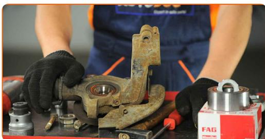
**37** Saque el cubo de rueda del muñón de dirección. Utilice un juego de cubos y rodamientos. Utilice un martillo.
