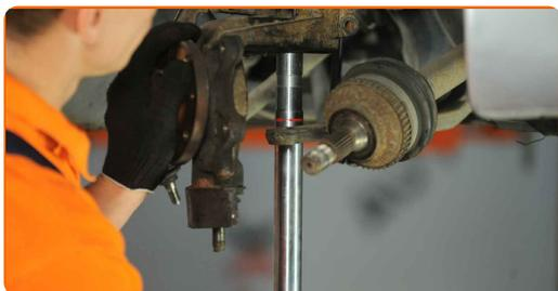
**50** Fije la pata amortiguadora en el muñón de dirección. Utilice un martillo.
