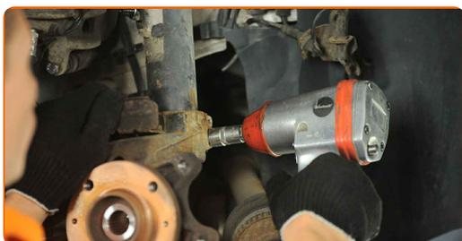
**34** Retire el perno de sujeción.
