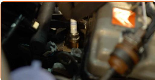
**18** Atornille las bujías nuevas y apriételas. Use el vaso de bujía # 16. Utilice una llave dinamo-métrica. Apriételo a un par de 28 Nm.
