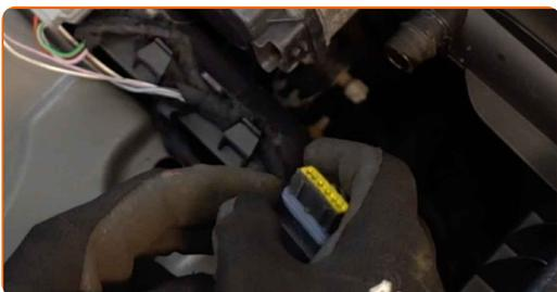
**8** Desconecte el conector de la bobina de ignición.
