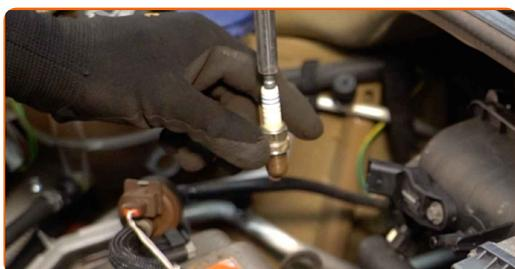
**16** Aplique una capa fina de un lubricante antigripado especial de alta temperatura a las roscas de las nuevas bujías.
