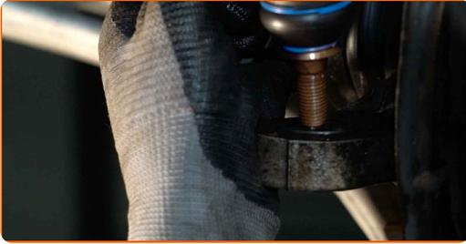
**16** Apriete la tuerca de fijación que conecta el extremo de la barra de acoplamiento a la mangueta de dirección. Use un vaso de impacto del n.º 17. Utilice una llave dinamométrica. Apriételo a un par de 35 Nm.
