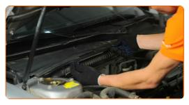
Saque de la carcasa del filtro el elemento filtrante de recambio. Utilice un destornillador plano.
