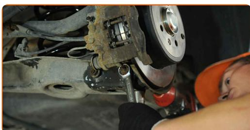
**24** Apriete la fijación inferior del amortiguador. Usa una llave mixta del n.º 18. Use un vaso de impacto del n.º 18. Utilice una llave dinamométrica. Apriételo a un par de 75 Nm.
