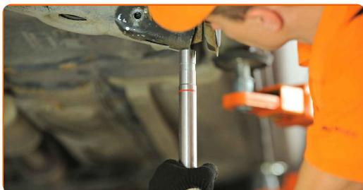
**23** Apriete la sujeción que conecta el brazo de control con la mangueta trasera. Usa una llave mixta del n.º 21. Use un vaso de impacto del n.º 21. Utilice una llave dinamométrica. Apriételo a un par de 95 Nm.
