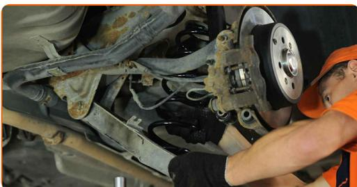
**19** Apoye el brazo de control trasero. Utilice un gato de transmisión hidráulica.
