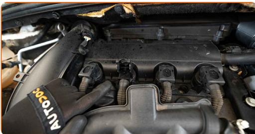
4 Desconecte el conector de la bobina de ignición.
