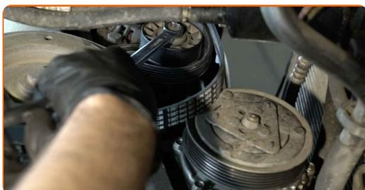
**9** Coloque la correa acanalada en V en la polea tensora.
