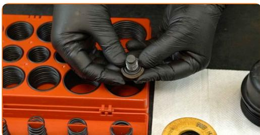
**17** Instale una junta tórica nueva en la tapa del filtro de aceite.
