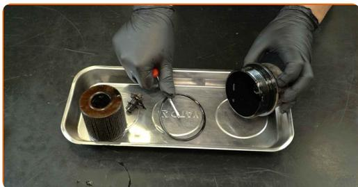
**13** Retire la junta tórica del tapón de drenaje. Utilice un destornillador plano.
