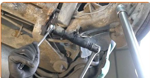
**10** Retire el perno de sujeción.
