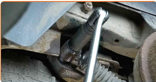
**9** Destornille la fijación inferior del amortiguador. Usa una llave mixta del n.º 24. Use un vaso de impacto del n.º 24. Utilice una llave de trinquete.
