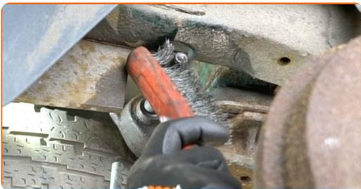
**13** Trate los asientos de montaje del amortiguador. Use grasa de cobre.
