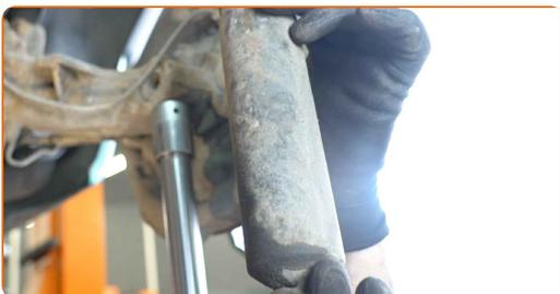
**12** Limpie los asientos de montaje del amortiguador. Use un cepillo de alambre. Use el aerosol WD-40.
