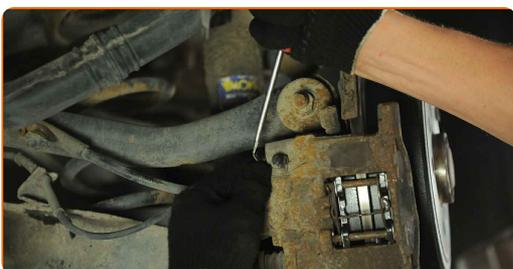
**8.1** Desenrosque las sujeciones de la pinza de freno. Use Vaso HEX No. H7.
