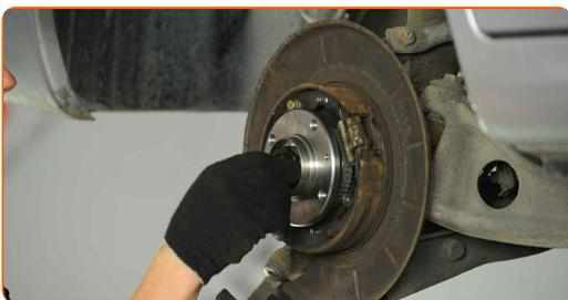
**23** Apriete la sujeción del cubo. Use un vaso de impacto del n.º 41. Utilice una llave dinamométrica. Apriételo a un par de 275 Nm.
