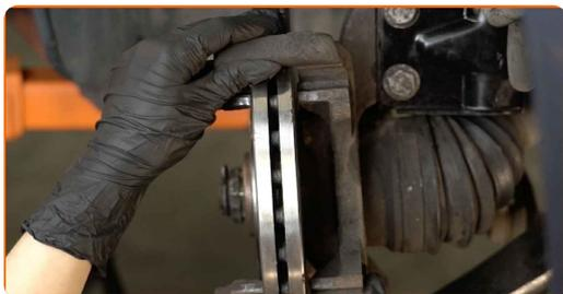
**26** Apriete la fijación de la pinza del cáliper de freno. Utilice Torx T50. Utilice una llave dinamométrica. Apriételo a un par de 105 Nm.
