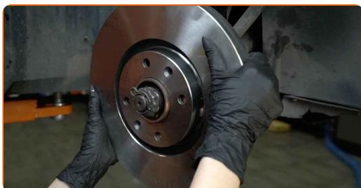
**23** Apriete la fijación del disco de freno. Utilice Torx T30. Utilice una llave dinamométrica. Apriételo a un par de 9 Nm.
