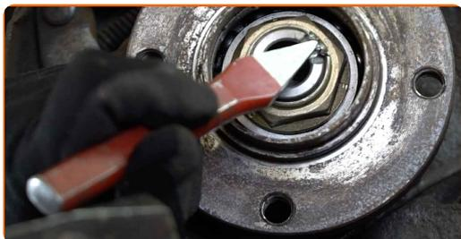
**11** Destornille la fijación del cubo de la rueda. Use un vaso de impacto del n.º 34. Utilice una llave giramachos.
