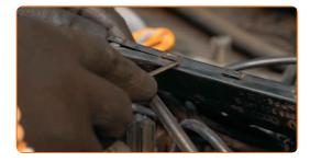
Realice marcas en la tapa del distribuidor con el fin de indicar el orden de instalación de los cables de las bujías.
