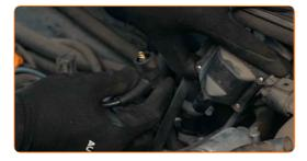
Conecte los nuevos cables de la bujía a la tapa del distribuidor.
