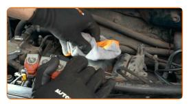
16 Instale la carcasa del filtro de aire y fíjela. Utilice un destornillador Phillips.
