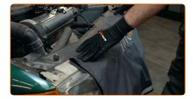
Desenrosque las sujeciones de la carcasa del filtro de aire. Utilice un destornillador Phillips.
