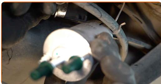
**13** Apriete la fijación del filtro de combustible. Utilice un destornillador Phillips.
