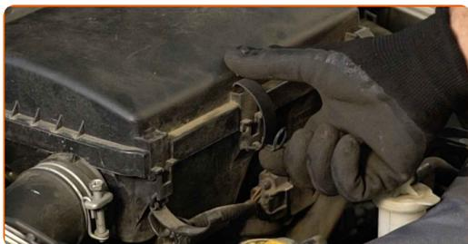
**4** Limpie la cubierta y la carcasa del filtro de aire.
