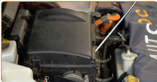
**5** Levante ligeramente la cubierta de la carcasa del filtro de aire.
