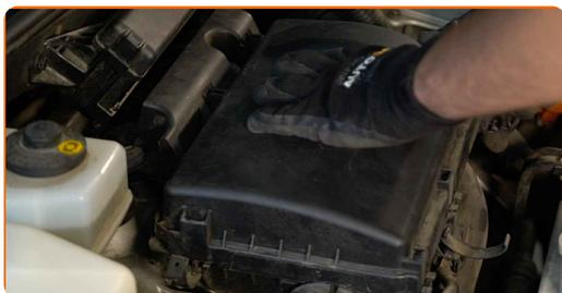
**12** Presione los clips de la cubierta del filtro de aire en su lugar.
