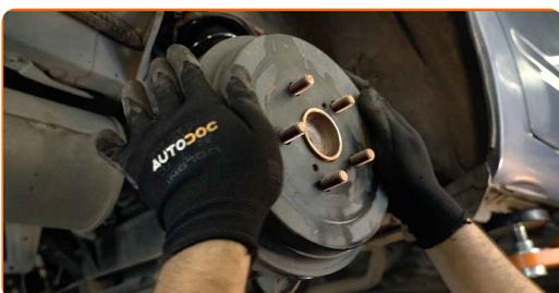
**21** Trate la superficie en la cual la llanta de la rueda entra en contacto con el tambor del freno. Use grasa de cobre.
