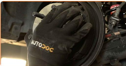
**15** Apriete la sujeción del rodamiento de cubo de rueda. Use un vaso de impacto del n.º 10. Utilice una llave dinamométrica. Apriételo a un par de 61 Nm.
