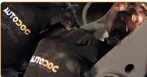
**18** Conecte el conector del sensor ABS.
