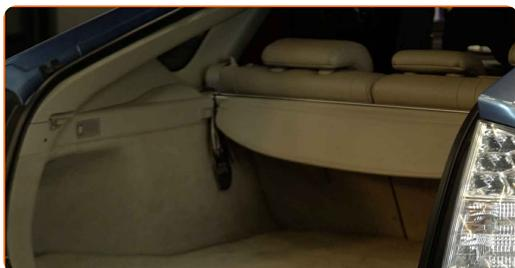
**2** Mueva el estante plegable y libérelolo de las sujeciones. Al efectuar esto, obtendrá acceso a los paneles de plástico del revestimiento lateral.
