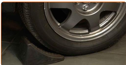
**19** Afloje los pernos de fijación de la rueda. Utilice una llave de impacto para llanta # 21.
