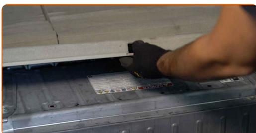
**9** Separe el revestimiento de la parte lateral del maletero.
