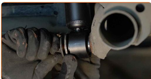
**50** Sostenga el eje de torsión de la suspensión trasera. Utilice un gato de transmisión hidráulica.
