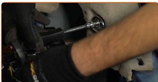
**16** Desconecte la manguera de aire del calentador.
