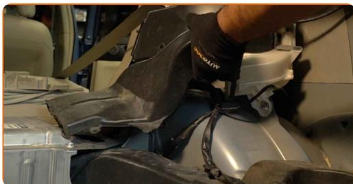
**17** Afloje la sujeción superior del soporte del amortiguador. Use un vaso de impacto del n.º 14. Utilice una llave de trinquete.
