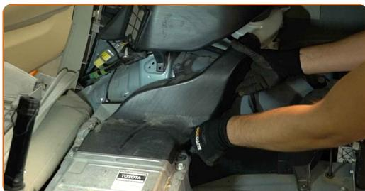
**58** Instale el aislamiento acústico de la parte lateral del maletero y atornille las sujeciones.
