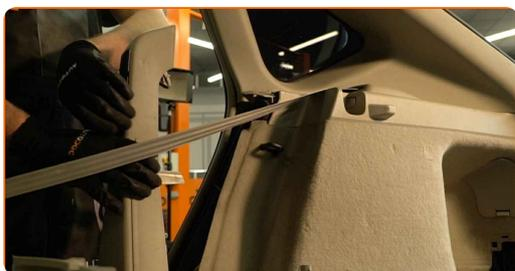
**13** Desatornille las sujeciones del panel de plástico del revestimiento lateral. Use un vaso de impacto del n.º 10. Utilice una llave de trinquete.
