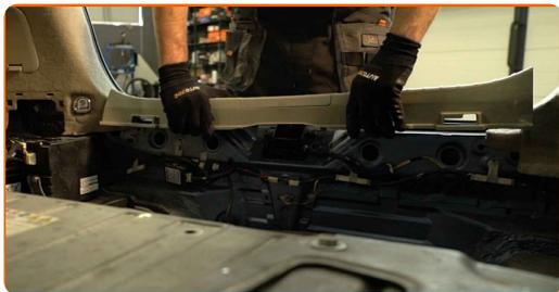
**15** Desatornille la sujeción y retire el aislamiento acústico de la parte lateral del maletero. Use un vaso de impacto del n.º 10. Utilice una llave de trinquete.
