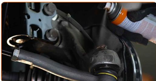
**24** Trate la superficie donde el disco del freno entra en contacto con la llanta de la rueda. Use grasa de cobre.
