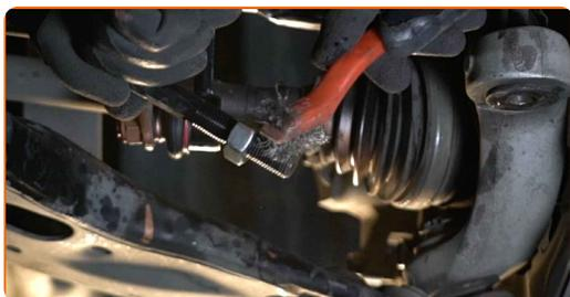
**14** Trate la parte roscada de la barra de acoplamiento de dirección. Use grasa de cobre.
