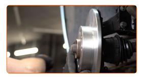
Apriete la fijación del disco de freno. Use un vaso de impacto del n.º 12. Utilice una llave dinamométrica. Apriételo a un par de 9 Nm.
