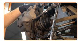
Retire la pinza del freno junto con su soporte.
