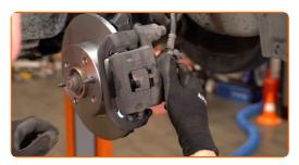
Instale la sujeción de la pinza de freno.
