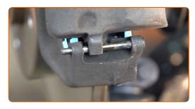
Instale el tornillo clavija de la pinza de freno.
