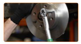
17 Instale la pinza del freno junto con su soporte.
