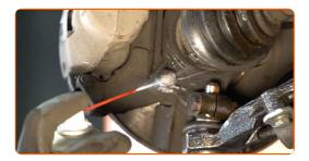
Destornille la fijación de la pinza del cáliper de freno. Use un vaso de impacto del n.º 17. Utilice una llave de trinquete. Utilice una llave giramachos.
