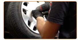
Baje el automóvil y, manteniendo el orden cruzado, apriete los pernos de fijación de las ruedas. Utilice una llave dinamométrica. Apriételo a un par de 86 Nm.
