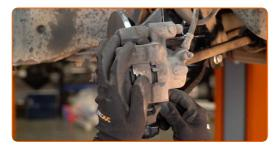
Apriete la fijación de la pinza del cáliper de freno. Use un vaso de impacto del n.º 17. Utilice una llave dinamométrica. Apriételo a un par de 57 Nm.
