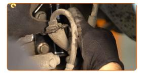
Apriete la sujeción del latiguillo de freno. Use un vaso de impacto del n.º 12. Utilice una llave de trinquete.
