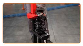
Retire el puntal amortiguador que está montado.
