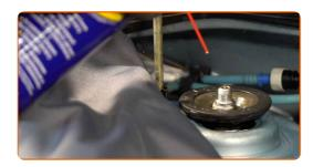
Afloje la sujeción superior del soporte del amortiguador. Use Vaso HEX No. H6. Use un vaso de impacto del n.º 19. Utilice una llave de trinquete.
