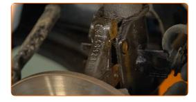
Destornille la fijación superior de la cazoleta de la pata amortiguadora. Use un vaso de impacto del n.º 19.
