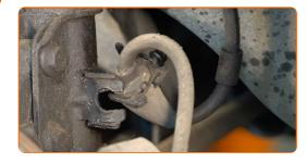
Limpie las sujeciones que conectan el puntal amortiguador a la mangueta de dirección. Use un cepillo de alambre. Use el aerosol WD-40.
