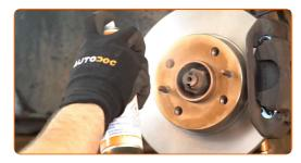
Limpie la superficie de la pinza del freno. Use un limpiador de frenos. Sustitución: amortiguador telescópico - Fiat Punto 188. Los expertos de AUTODOC recomiendan: Después de aplicar el aerosol, espere unos minutos.
