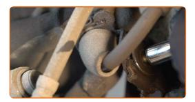
Separe el latiguillo de freno del puntal amortiguador.
