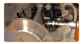
Apriete las sujeciones inferiores que conectan el amortiguador con la mangueta de dirección. Use un vaso de impacto del n.º 15. Usa una llave mixta del n.º 17. Utilice una llave dinamométrica. Apriételo a un par de 75 Nm.
