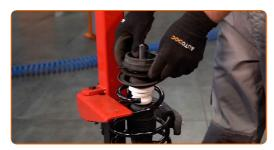
Apriete la tuerca de la varilla de la pata amortiguadora. Use Vaso HEX No. H6. Usa una llave mixta del n.º 27. Utilice una llave dinamométrica. Apriételo a un par de 59 Nm.
