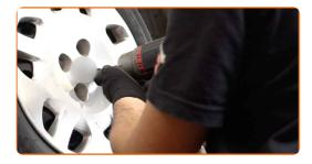
Baje el automóvil y, manteniendo el orden cruzado, apriete los pernos de fijación de las ruedas. Utilice una llave dinamométrica. Apriételo a un par de 86 Nm.
