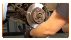
Retire los pernos de sujeción. Use una palanca.
