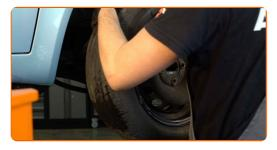
Limpie las sujeciones de la bieleta o enlace estabilizador. Use un cepillo de alambre. Use el aerosol WD-40.
