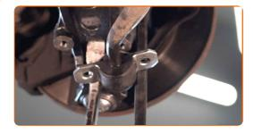
Instale los soportes del cojinete del estabilizador. Use una palanca.
