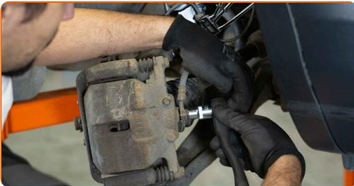
**14** Separe las pastillas de freno. Use una palanca.
