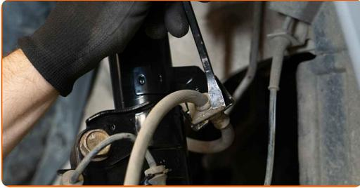
9 Separe el latiguillo de freno del puntal amortiguador.
