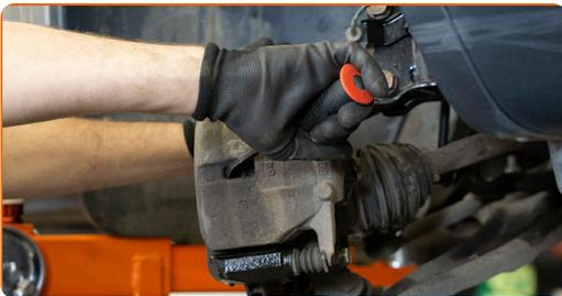
**15** Destornille la fijación del cáliper de freno. Use un vaso de impacto del n.º 14. Utilice una llave de trinquete.
