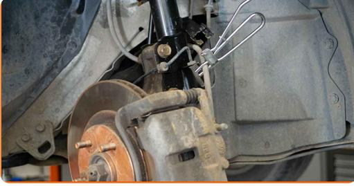
**13** Destornille el latiguillo de freno del cáliper de freno. Use un vaso de impacto del n.º 12. Utilice una llave de trinquete.
