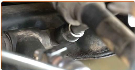
**16** Retire la sujeción delantera del brazo de control.
