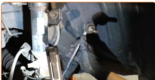
**15** Destornille la fijación delantera de la palanca. Use un vaso de impacto del n.º 21. Utilice una llave giramachos.
