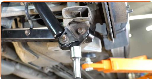
**20** Apriete la sujeción que conecta el brazo de suspensión a la mangueta trasera. Use una llave mixta del n.º 18. Use un vaso de impacto del n.º 21. Utilice una llave dinamométrica. Apriételo a un par de 150 Nm.
