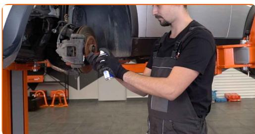
9 Separe el muelle de retención de la pinza de freno. Use una palanca.
