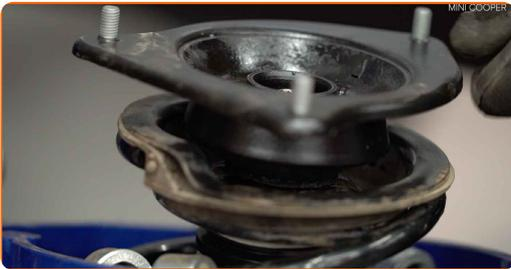
27 Apriete la tuerca de la varilla de la pata amortiguadora. Use un vaso de impacto del n.º 18. Use una llave mixta del n.º 18. Use Vaso HEX No. H7. Utilice una llave dinamométrica. Apriételo a un par de 64 Nm.
