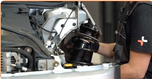
31 Fije las sujeciones superiores del puntal amortiguador (3 piezas). No lo apriete.
