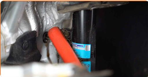
**9** Destornille la tuerca y quite la barra del estabilizador desde la pata amortiguadora. Usa una llave mixta del n.º 16. Use Vaso HEX No. H6. Utilice una llave de trinquete.
