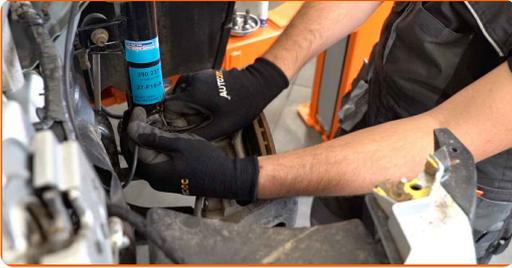
**8** Limpie las fijaciones que conectan la bieleta de la barra estabilizadora al puntal amortiguador, y aquellos que conectan el puntal del amortiguador a la mangueta de rueda. Use un cepillo de alambre. Use el aerosol WD-40.
