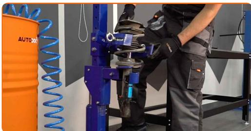
18 Destornille la tuerca de la varilla de la pata amortiguadora. Use Vaso HEX No. H7. Use un vaso de impacto del n.º 18. Utilice una llave de trinquete.
