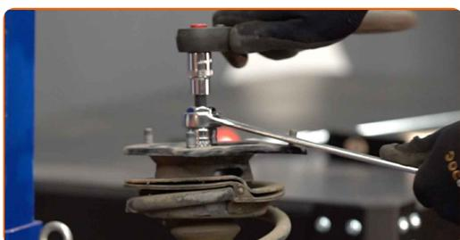
19 Retire el soporte del puntal amortiguador.
