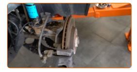
Limpie las sujeciones del soporte superior del puntal amortiguador. Use el aerosol WD-40.
