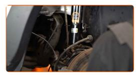
Instale y apriete un nuevo perno de la mangueta de dirección. Utilice las puntas XZN #14. Utilice una llave dinamométrica. Apriételo a un par de 81 Nm.
