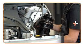
Fije la tuerca de fijación superior en la pata amortiguadora. No lo apriete.
