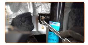
Desatornille la sujeción inferior que conecta el puntal amortiguador a la mangueta de dirección. Use un vaso de impacto del n.º 18. Utilice una llave de trinquete. Utilice una llave giramachos.
