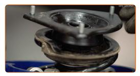
Apriete la tuerca de la varilla de la pata amortiguadora. Use un vaso de impacto del n.º 18. Usa una llave mixta del n.º 18. Use Vaso HEX No. H7. Utilice una llave dinamométrica. Apriételo a un par de 64 Nm.
