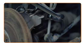
Suelte la sujeción inferior que conecta el puntal amortiguador a la mangueta de dirección. Utilice un vaso de impacto especial para extraer el amortiguador. Utilice una llave de trinquete.
