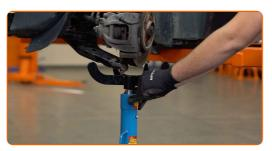
Desconecte el muñón de dirección de la pata amortiguadora. Utilice un cincel de metal plano. Utilice un martillo.
