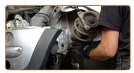
16 Instale la pata amortiguadora en el mecanismo para apretar los resortes.
