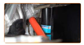
Destornille la tuerca y quite la barra del estabilizador desde la pata amortiguadora. Usa una llave mixta del n.º 16. Use Vaso HEX No. H6. Utilice una llave de trinquete.
