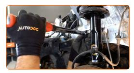
Conecte la fijación del cable del sensor ABS a la pata amortiguadora. En la pata fije el latiguillo del sistema de freno.
