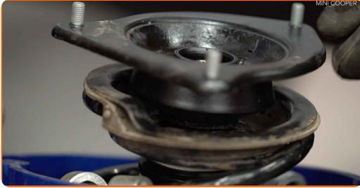
21 Apriete la tuerca de la varilla de la pata amortiguadora. Use un vaso de impacto del n.º 18. Use una llave mixta del n.º 18. Use Vaso HEX No. H7. Utilice una llave dinamométrica. Apriételo a un par de 64 Nm.
