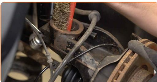
26 Fije la pata amortiguadora en el muñón de dirección.
