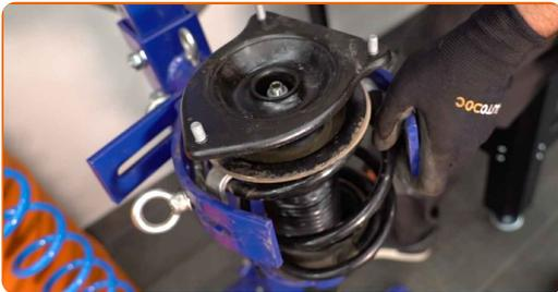
Sustitución: copelas del amortiguador - Mini R50, R53. Consejo de los expertos de AUTODOC:
