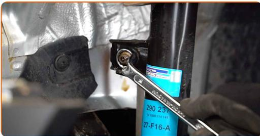
**10** Desatornille la sujeción inferior que conecta el puntal amortiguador a la mangueta de dirección. Utilice las puntas XZN #14. Utilice una llave de trinquete. Utilice una llave giramachos.
