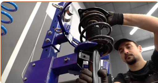
23 Instale la pata amortiguadora en el arco de la rueda.
