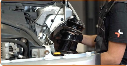
24 Fije las sujeciones superiores del puntal amortiguador (3 piezas). No lo apriete.
