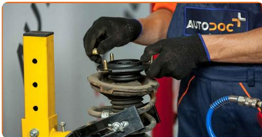
**29** Apriete la tuerca de la varilla de la pata amortiguadora. Use un vaso de impacto del n.º 19. Utilice una llave dinamométrica. Apriételo a un par de 47 Nm.
