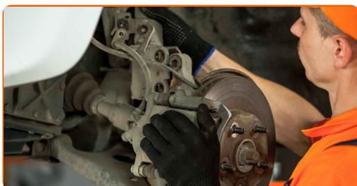
**42** Fije la pata amortiguadora en el muñón de dirección. Use una palanca.
