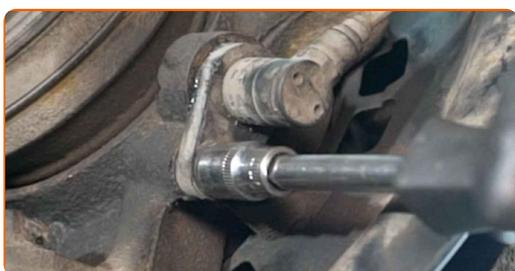
**76** Apriete las sujeciones que conectan la rótula al brazo de control. Use un vaso de impacto del n.º 17. Utilice una llave dinamométrica. Apriételo a un par de 75 Nm.
