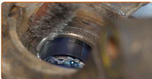
**43** Retire el anillo de retención del cojinete del cubo de rueda. Utilice alicates para arandelas.
