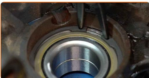
**49** Limpie el asiento de montaje del cojinete del cubo (buje). Use un cepillo de alambre. Use el aerosol WD-40.
