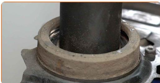
**46** Limpie el asiento de montaje del cojinete del cubo (buje). Use un cepillo de alambre. Use el aerosol WD-40.
