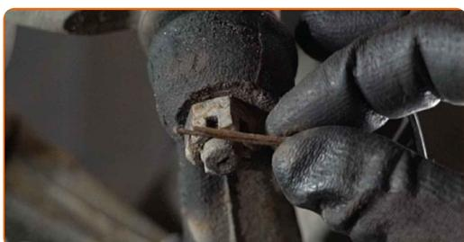
**24** Limpie las sujeciones que conectan el extremo de la barra de acoplamiento con la mangueta de dirección. Use un cepillo de alambre. Use el aerosol WD-40.
