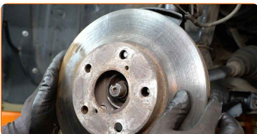
**65** Limpie el asiento de montaje del soporte de la pinza de freno. Use un cepillo de alambre. Use el aerosol WD-40.
