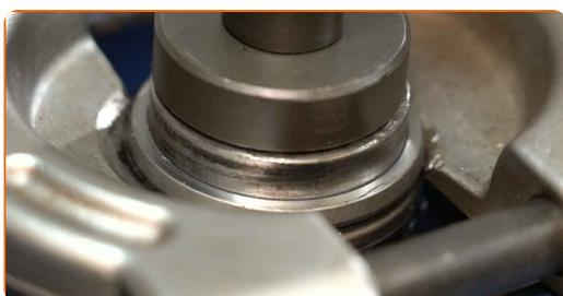
**45** Presione para extraer el cojinete del cubo de rueda. Utilice un juego de cubos y rodamientos.
