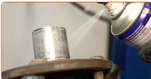
**50** Instale el cubo de rueda en el muñón de dirección. Utilice un juego de cubos y rodamientos.
