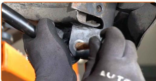
**30** Instale la barra del estabilizador de estabilidad transversal.
