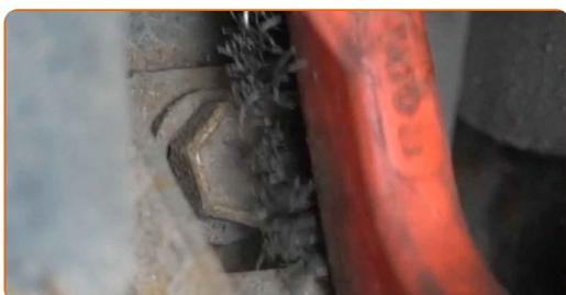
**14** Destornille la fijación inferior del amortiguador. Use un vaso de impacto del n.º 14. Utilice una llave de trinquete.
