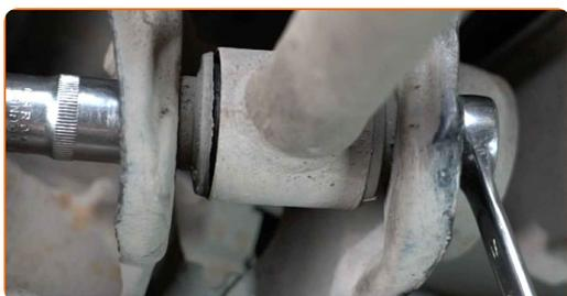
**23** Retire el perno de sujeción. Use una palanca.
