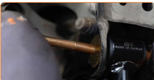
**28** Ajuste la posición del perno de alineación según la marca.
