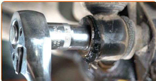
**15** Retire el perno de sujeción.
