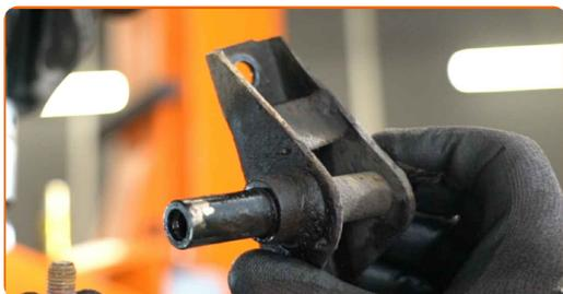
**20** Retire el perno de sujeción. Use un punzón. Utilice un martillo.
