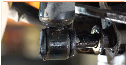
**17** Desenrosque las sujeciones del soporte que conecta el amortiguador con la mangueta trasera. Use un vaso de impacto del n.º 14. Utilice una llave de trinquete.
