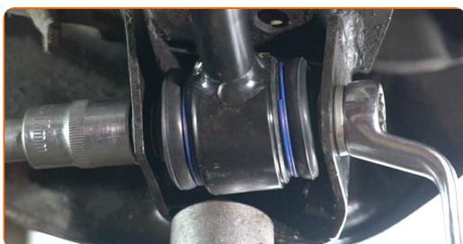
**34** Apriete la sujeción que conecta el brazo de control con el subchasis. Use una llave mixta del n.º 17. Use un vaso de impacto del n.º 17. Utilice una llave dinamométrica. Apriételo a un par de 113 Nm.
