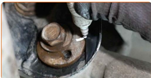
**22** Desenrosque la sujeción que conecta el brazo de control con el subchasis. Usa una llave mixta del n.º 17. Use un vaso de impacto del n.º 17. Utilice una llave de trinquete.
