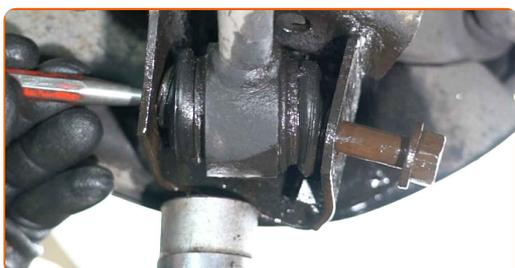
**21** Haga una marca en el perno de ajuste de la inclinación.
