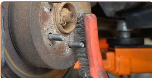
**51** Trate la superficie donde el disco del freno entra en contacto con la llanta de la rueda. Utilice grasa cerámica.
