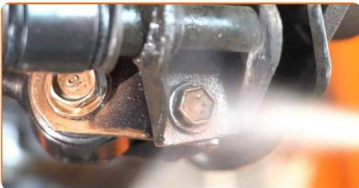
**49** Trate las sujeciones del amortiguador. Use grasa de cobre.
