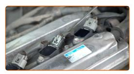
Desconecte los conectores de las bobinas del encendido.
