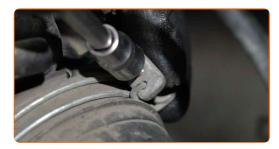
Atornille las sujeciones de la carcasa del filtro de aire. Use un vaso de impacto del n.º 10. Utilice una llave de trinquete.
