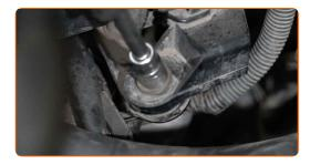
Conecte el tubo de entrada de aire a la carcasa del filtro de aire.
