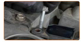
Extraiga las bobinas del encendido de los pozos de la bujía.
