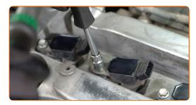
Trate el conector de la bobina de encendido con spray para electrónica. El spray protegerá los contactos eléctricos de la corrosión, oxidación, y reducirá la resistencia de contacto.
