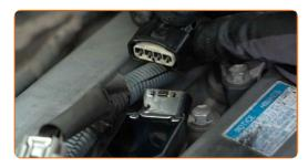
Desatornille las sujeciones de las bobinas del encendido. Use un vaso de impacto del n.º 10. Utilice una llave de trinquete.
