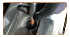
Atornille las buujías nuevas y apriételas. Use el vaso de bujía # 16. Utilice una llave dinamométrica. Apriételo a un par de 19 Nm.
