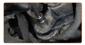
Afloje la abrazadera de sujeción que conecta el conducto de aire a la carcasa del filtro de aire. Use un vaso de impacto del n.º 10. Utilice una llave de trinquete.
