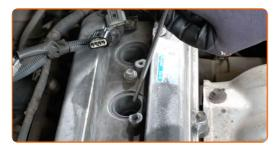
Desenrosque las bujías. Use el vaso de bujía # 16. Utilice una llave de trinquete.
