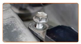
Apriete las sujeciones de la bobina de ignición. Use un vaso de impacto del n.º 10. Utilice una llave dinamométrica. Apriételo a un par de 9 Nm.
