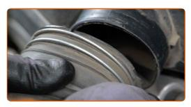
Desenrosque las sujeciones de la carcasa del filtro de aire. Use un vaso de impacto del n.º 10. Utilice una llave de trinquete.
