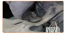
Retire el soporte de la carcasa del filtro de aire.
