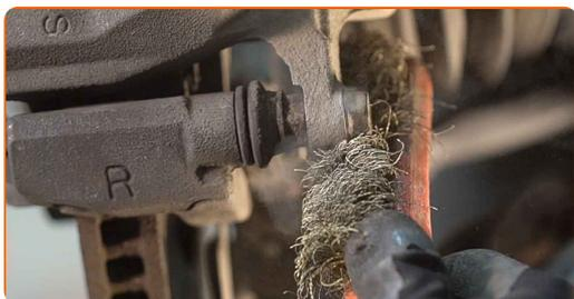
**9** Destornille la fijación del cáliper de freno. Use un vaso de impacto del n.º 14. Utilice una llave de trinquete.
