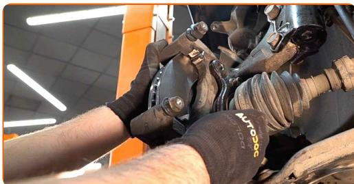
**20** Apriete la fijación de la pinza del cáliper de freno. Use un vaso de impacto del n.º 17. Utilice una llave dinamométrica. Apriételo a un par de 98 Nm.
