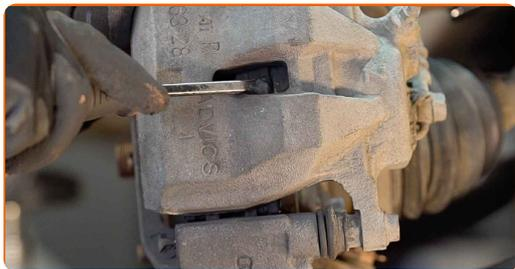
**8** Limpie las sujeciones de la pinza del freno. Use un cepillo de alambre. Use el aerosol WD-40.
