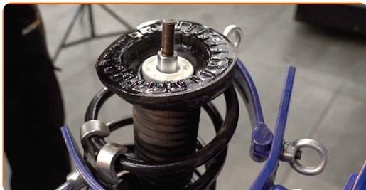
**32** Instale el soporte de montaje superior del puntal y el cojinete del soporte de montaje del puntal.
