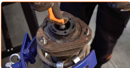
**24** Destornille la tuerca de la varilla de la pata amortiguadora. Utilice un soporte de polea universal. Use un vaso de impacto del n.º 19. Utilice una llave de trinquete.
