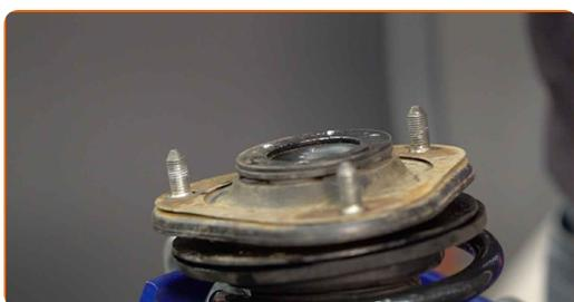
**33** Apriete la tuerca de la varilla de la pata amortiguadora. Utilice un soporte de polea universal. Use un vaso de impacto del n.º 19. Utilice una llave dinamométrica. Apriételo a un par de 47 Nm.
