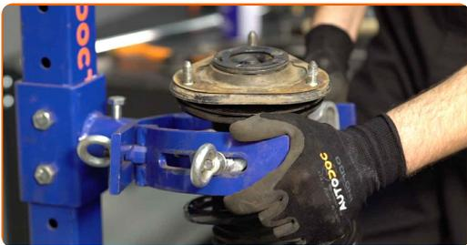
**35** Trate la varilla del amortiguador. Use grasa de cobre.
