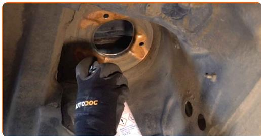
**40** Instale la pata amortiguadora en el arco de la rueda.
