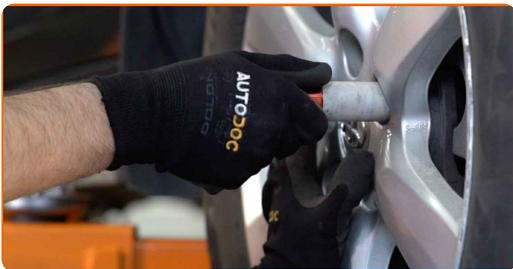
**56** Atornille la atadura superior del soporte del mostrador del amortizador. Use un vaso de impacto del n.º 14. Utilice una llave dinamométrica. Apriételo a un par de 50 Nm.
