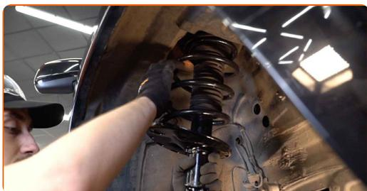
**41** Atornillen la fijación superior de la cazoleta de la pata amortiguadora. No lo apriete.
