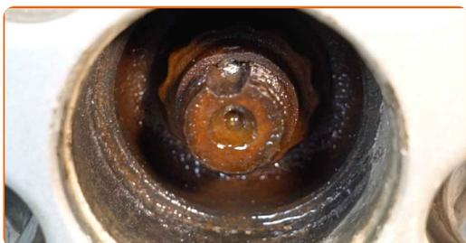
**3** Afloje la sujeción del eje de transmisión. Use un vaso de impacto del n.º 30. Utilice una llave giramachos.
