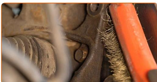
**31** Instale la pinza del cáliper de freno.
