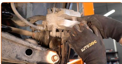
**32** Apriete la fijación de la pinza del cáliper de freno. Use un vaso de impacto del n.º 18. Utilice una llave dinamométrica. Apriételo a un par de 88 Nm.
