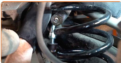
**13** Instale la fijación de la varilla a la palanca y apriétela. Use una llave mixta del n.º 17. Use un vaso de impacto del n.º 17. Utilice una llave dinamométrica. Apriételo a un par de 30 Nm.
