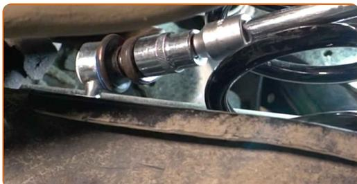
**15** Trate todas las juntas de la bieleta o enlace estabilizador. Use grasa de cobre.
