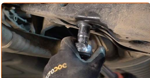
**14** Apriete la sujeción que conecta la bieleta a la barra estabilizadora. Use un vaso de impacto del n.º 17. Utilice una llave dinamométrica. Apriételo a un par de 74 Nm.
