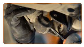
Limpie la sujeción del soporte del sensor ABS. Use el aerosol WD-40.
