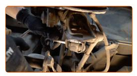
Separe la parte inferior del amortiguador. Use una palanca.
