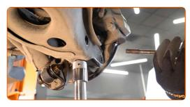
Limpie las sujeciones de la bieleta o enlace estabilizador. Use un cepillo de alambre. Use el aerosol WD-40.
