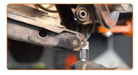
Apriete la fijación inferior del amortiguador. Usa una llave mixta del n.º 17. Use un vaso de impacto del n.º 17. Utilice una llave dinamométrica. Apriételo a un par de 80 Nm.
