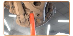
Destornille la fijación del brazo trasero transversal con el muñón. Use un vaso de impacto del n.º 17. Utilice una llave giramachos.
