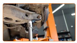
Atornille la fijación del brazo con el muñón. Use un vaso de impacto del n.º 17. Utilice una llave dinamométrica. Apriételo a un par de 90 Nm.
