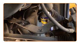
Destornille el soporte del cable ABS. Use un vaso de impacto del n.º 12. Utilice una llave de trinquete.
