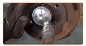
Trate la superficie en la cual la llanta de la rueda entra en contacto con el tambor del freno. Use grasa de cobre.
