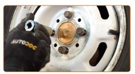
Baje el automóvil y, manteniendo el orden cruzado, apriete los pernos de fijación de las ruedas. Utilice una llave dinamométrica. Apriételo a un par de 90 Nm.
