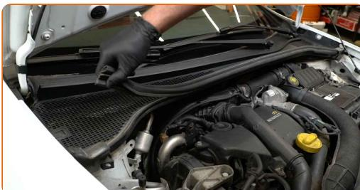
**4** Retire los clips de la rejilla del capó. Utilice una herramienta de extracción de clips.
