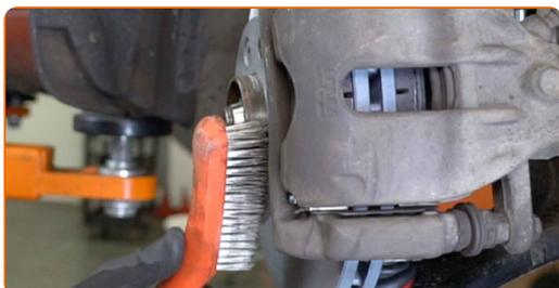
**15** Trate la superficie donde el disco del freno entra en contacto con la llanta de la rueda. Utilice grasa cerámica.
