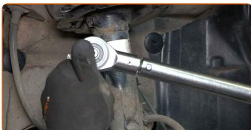
**13** Apriete la sujeción que conecta la bieleta a la barra estabilizadora. Use un vaso de impacto del n.º 17. Utilice una llave dinamométrica. Apriételo a un par de 44 Nm.
