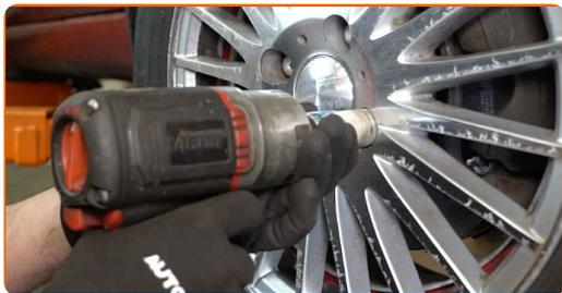
**42** Baje el automóvil y, manteniendo el orden cruzado, apriete los pernos de fijación de las ruedas. Utilice una llave de impacto para llanta # 17. Utilice una llave dinamométrica. Apriételo a un par de 110 Nm.
