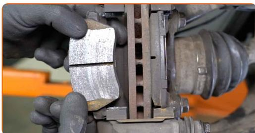
**14** Limpie las sujeciones del soporte de la pinza del freno. Use un cepillo de alambre. Use el aerosol WD-40.
