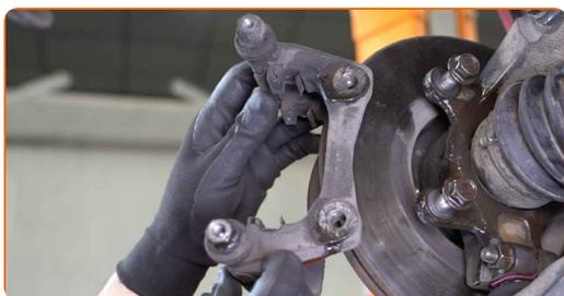
**18** Limpie las sujeciones del disco de freno. Use un cepillo de alambre. Use el aerosol WD-40.
