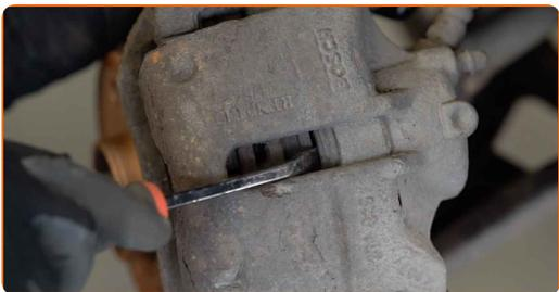
**8** Limpie la pinza del cáliper de freno de polvo y suciedad. Use un cepillo de alambre. Use el aerosol WD-40.
