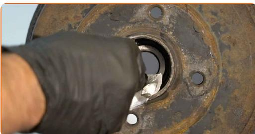
**11** Retire el anillo de retención del cojinete del cubo de rueda. Utilice alicates para arandelas.
