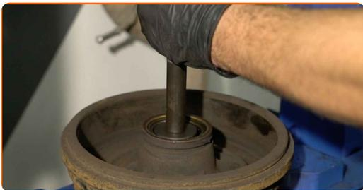
**13** Limpie el asiento de montaje del cojinete del cubo (buje). Use el aerosol WD-40.
