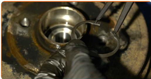
**16** Limpie el asiento de montaje del cojinete del cubo (buje). Utilice un spray de limpieza multiuso.
