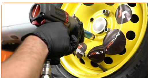
**25** Baje el automóvil y, manteniendo el orden cruzado, apriete los pernos de fijación de las ruedas. Utilice una llave de impacto para llanta # 17. Utilice una llave dinamométrica. Apriételo a un par de 105 Nm.
