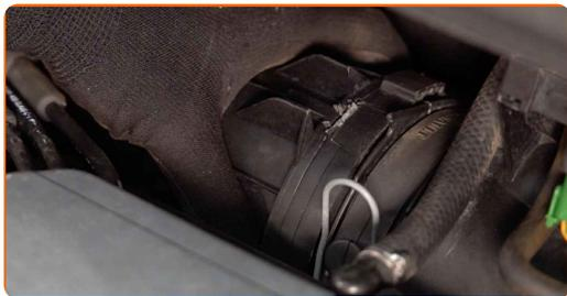
**9** Presione los clips de la cubierta del filtro de aire en su lugar.
