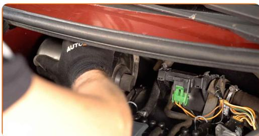
**5** Saque de la carcasa del filtro el elemento filtrante de recambio.
