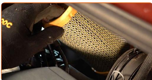
**6** Limpie la cubierta y la carcasa del filtro de aire.
