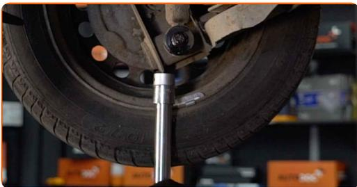
**13** Destornille la fijación inferior del amortizador. Use un vaso de impacto del n.º 18.
