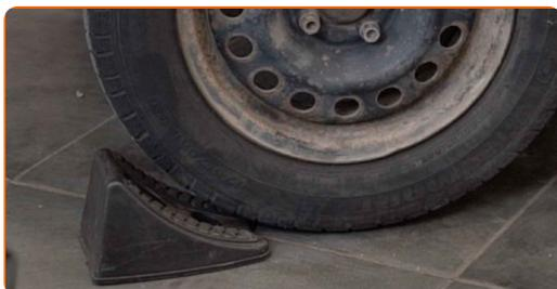
**2** Afloje los pernos de fijación de la rueda. Utilice una llave de impacto para llanta # 19.
